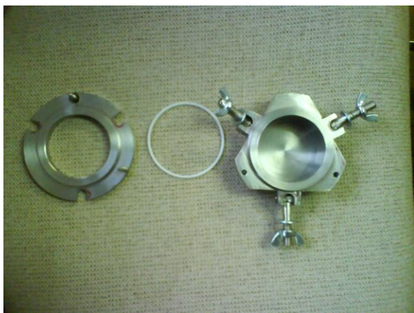
Слика 6. Цртеж апарата за одређивање апсорпције водене паре (из SRPS EN 420) (1 – горња прирубница, 2 – заптивач, 3 – узорак, 4 – доња прирубница)
