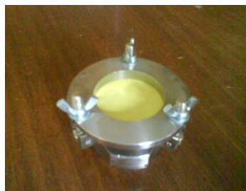
Слика 7. Израђен апарат за одређивање апсорпције водене паре (делови према слици 6, поглед са стране, апарат са узорком)
