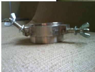
Слика 7. Израђен апарат за одређивање апсорпције водене паре (делови према слици 6, поглед са стране, апарат са узорком)
