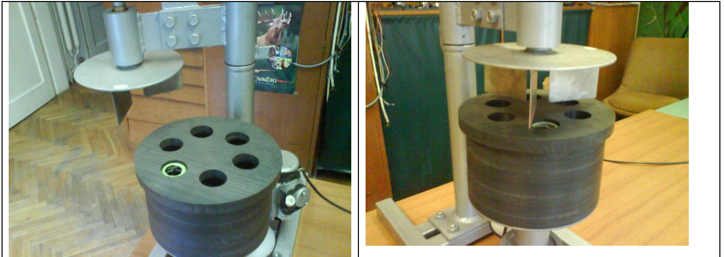
Слика 4. Постоље са поклопцем (положај вентилатора при намештању узорка и радни положај)
